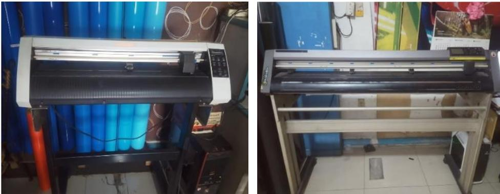
Gambar 2. Proses pemotongan stiker menggunakan mesin cutting berbasis CAD/CAM di Stickermax.
